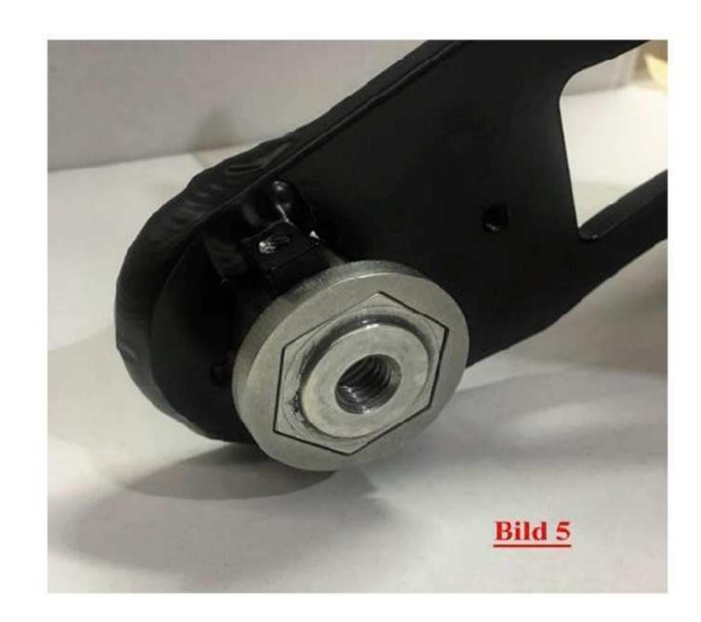
Bild 5 & 6: Nachdem Sie nun den Halter auf die Achsmutter gesteckt haben, benötigen Sie entweder eine Innensechskantscheibe (so wie hier in der Abbildung oder eine von den Distanzscheiben oder beides, je nach Motorradtyp. Wichtig ist das die Abschlussscheibe direkt auf den Kennzeichenhalter wirken kann und diesen durch den Anpressdruck fixiert. Dadurch wird der Kennzeichenhalter eingeklemmt und gehalten.
