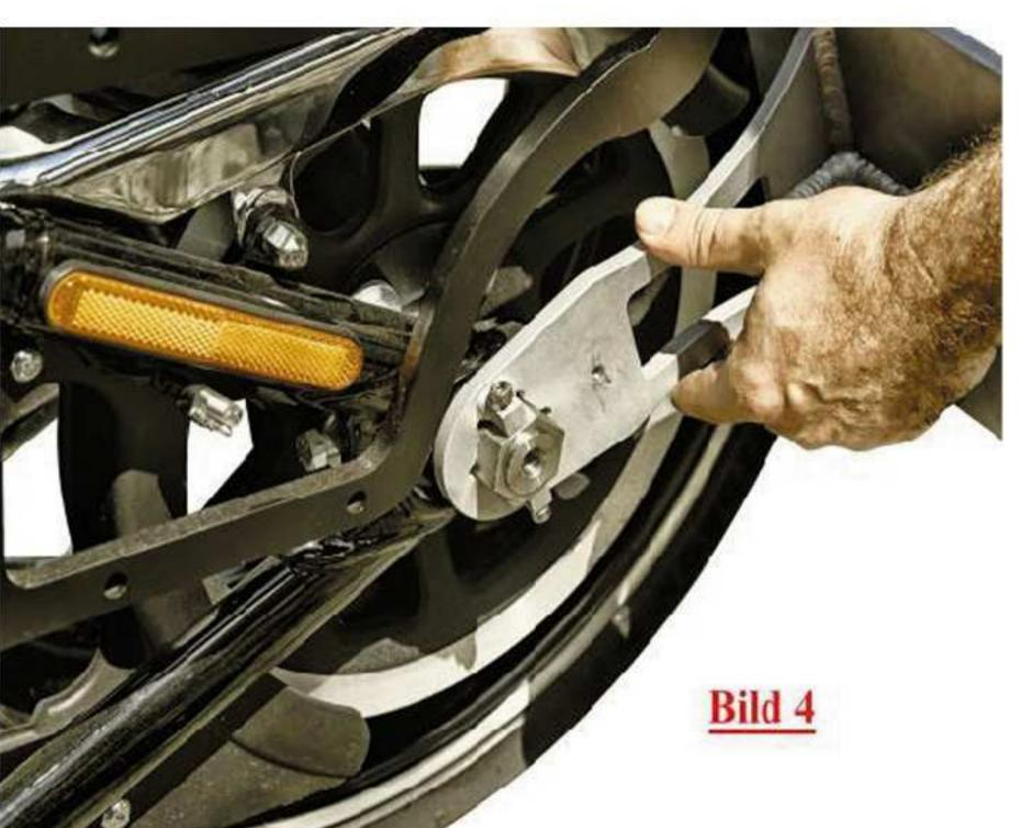
Bild 4: Jetzt können Sie den Kennzeichenhalter auf die Achsmutter schieben, bis er an der Schwinge anliegt. Sollte Ihnen der Winkel des Halters nicht zusagen, müssen Sie die Mutter etwas lösen, die Achse entsprechend verdrehen und die Mutter wieder ordnungsgemäß festziehen.
