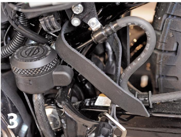
Links: Hier noch einmal eine Detailaufnahme von dem Rohr, das sich weit hinter der Bremsleitung befindet. Bei älteren Sportster-Modellen ist dieser Punkt sehr viel leichter auszumachen und zu erreichen.
