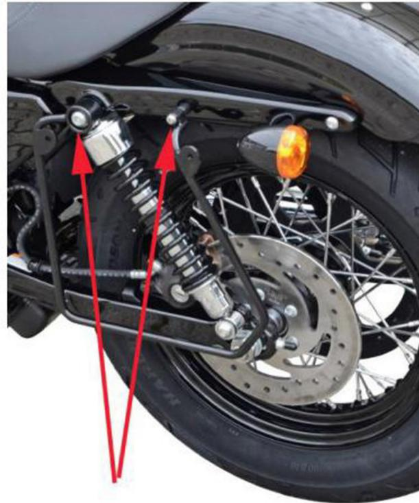
Der Satteltaschenhalter wird mit 2 Schrauben verschraubt. Die vordere Verschraubung erfolgt mit dem Stoßdämpfer. Bei der hinteren Befestigung wird die serienmäßige Verschraubung mit den Struts entfernt. Für die Verschraubung des Satteltaschenhalters mit den Struts werden Distanzhülsen und Montagematerial mitgeliefert.
