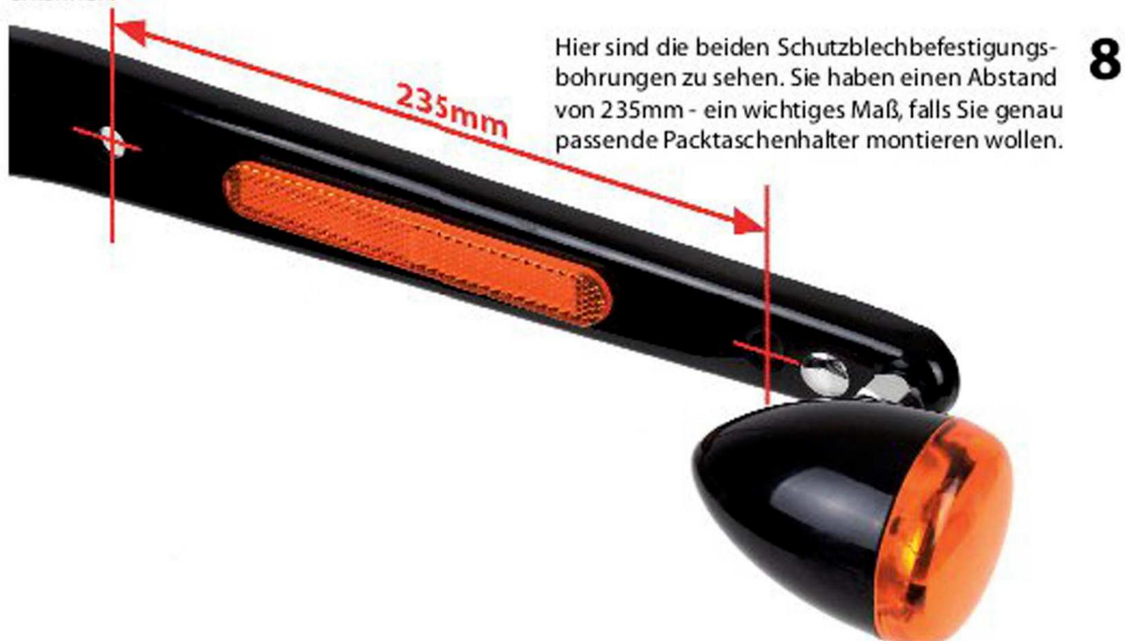
Hier sind die beiden Schutzblechbefestigungsbohrungen zu sehen. Sie haben einen Abstand von 235mm - ein wichtiges Maß, falls Sie genau passende Packtaschenhalter montieren wollen.
