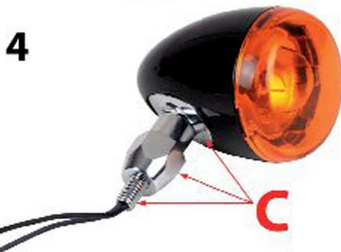
Der Haltearm hat zwei flache Seiten, an denen sich ein 13er oder 1/2" Schlüssel ansetzen lässt. Die Gegenmutter hat eine Schlüsselweite von 3/4", ein 19er Schlüssel passt auch. Die Haltemutter hat eine Schlüsselweite von 5/8", hier hilft notfalls ein 17er Schlüssel weiter, der jedoch etwas zu groß ist und deshalb leicht abrutschen kann.
