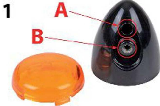
Zuerst müssen die Blinker demontiert und zerlegt werden. Der Kabelschlauch um die beiden Blinkerkabel muss entfernt werden. Der Kabelausgang A (Bild 1) ist hinfällig, die Kabel werden nun durch Öffnung B geführt. Bild 2 zeigt die durchgesteckten Kabel.
