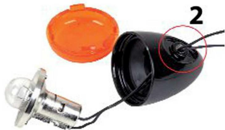
Achten Sie darauf, dass die Lampenhalterung wieder perfekt im Lampenhaus sitzt, bevor Sie das Lampenglas wieder aufsetzen. Die Birne sitzt bauartbedingt sehr nahe am Lampenglas, darum muss die Fassung ausreichend tief im Gehäuse stecken.
