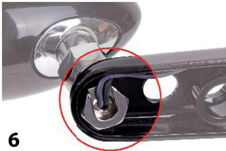
Der Blinker ist nun an der hintersten Bohrung des Fender Strut befestigt - es sollte also so aussehen wie auf Bild 7. Davor liegen zwei weitere Bohrungen: Bohrung 1 dient zur Befestigung des Schutzbleches, Bohrung 2 diente ursprünglich als Durchführung des Blinkerkabels und ist nun überflüssig. Sie können diese leicht ovale Bohrung eventuell mit einer Chromkappe abdecken, die mit Montagekleber fixiert werden sollte. Auf Bild 8 ist eine solche Abdeckung zu erkennen.
