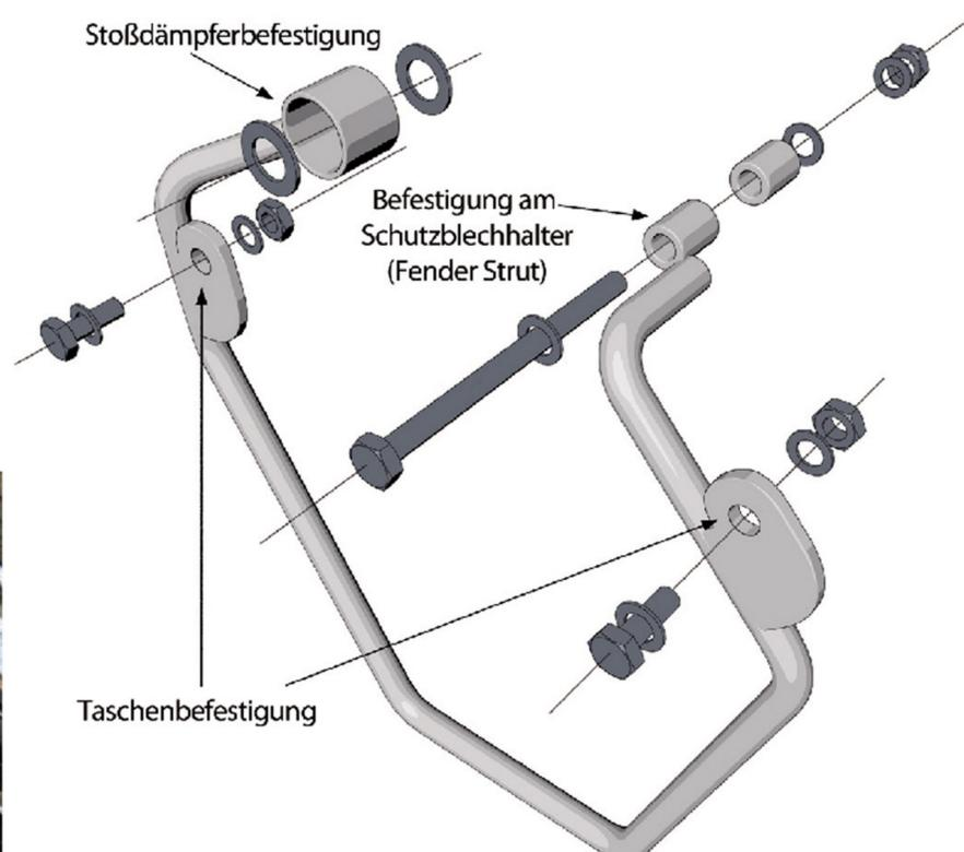
Der Satteltaschenhalter wird mit 2 Schrauben verschraubt. Die vordere Verschraubung erfolgt mit dem Stoßdämpfer. Hierzu verwenden Sie bitte die original Schraube sowie die beiden U-Scheiben 13x24mm. Bei der hinteren Befestigung wird die serienmäßige Verschraubung mit den Struts entfernt. Für die Verschraubung des Satteltaschenhalters mit den Struts werden Distanzhülsen und Montagmaterial mitgeliefert. Im Lieferumfang sind unterschiedliche Längen der Schrauben enthalten.
