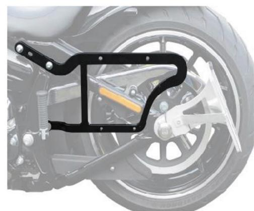
Abb.3: Nach der Montage des Halters wird die Position der Tasche am Halter festgelegt. Unsere Taschen haben auf der Rückseite eine durchgehende, eingenähte Platte. So können Sie die Position der Tasche selbst festlegen. Zeichnen Sie die Löcher an und bohren Sie diese dann mit einem 8mm Bohrer. Zur Befestigung der Tasche verwenden Sie bitte die beiden M8x30 Schrauben, die U-Scheiben 8,4 und die beiden selbstsichernden Muttern.
