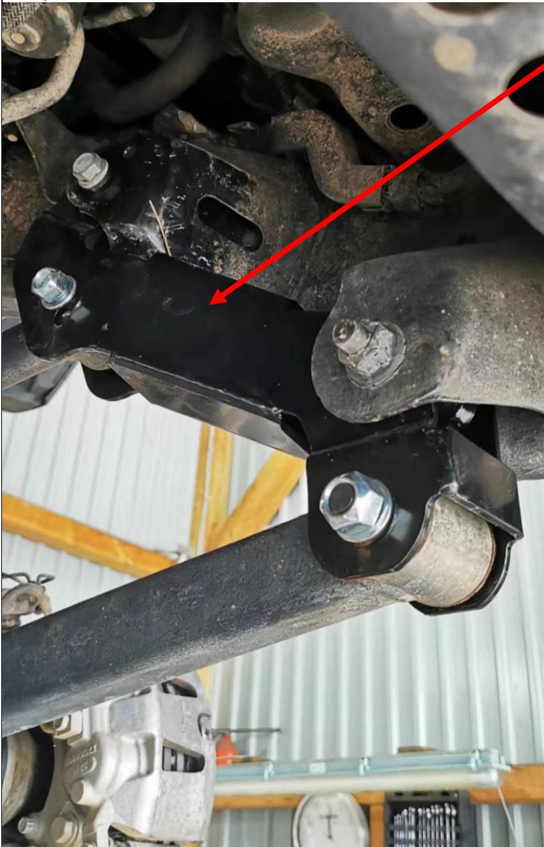
*Optional ist die hier gezeigte Längslenker Absenkung HSP-7 zu verbauen / Optionally, the geo correction bracket HSP-7 shown here can be installed.*
