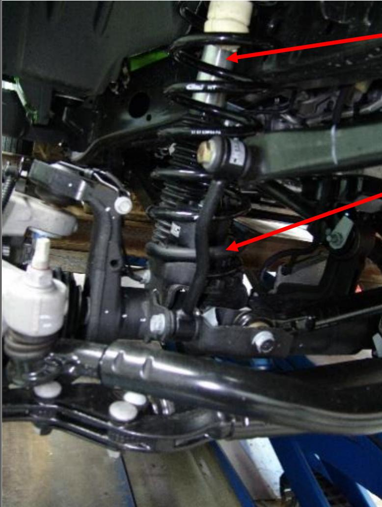
Höherlegungs Stoßdämpfer (33-292625) an den serienmäßigen Punkten verschrauben (Faltenbalg zeigt nach unten!) / Screw the shock absorber (33-292625) to the standard fixing points (gaiter downwards!)
