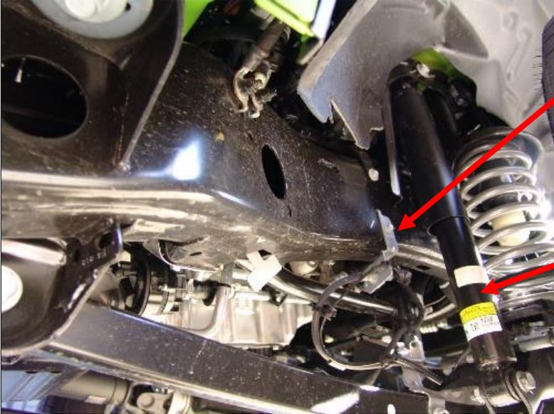
*Schraube für Halter Bremsschlauch am Rahmen entfernen, Bremsschlauchhalter am Rahmen aushängen und entfernen / Remove the screw for the brake hose bracket at the frame, unhook the brake hose bracket at the frame and remove*
