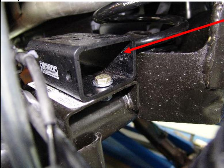
Federwegbegrenzer (HSP-4) auf der Hinterachse mit den beiliegenden Schrauben befestigen / Fasten the bump stop (HSP-4) on the rear axle with the screws provided
