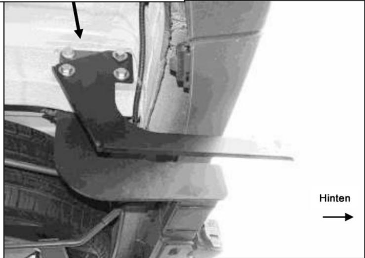
**Bild 5** Bei Modellen mit Anhängerkupplung wird die Halterung für die Beifahrerseite an der Außenseite der Fahrerseite befestigt.
