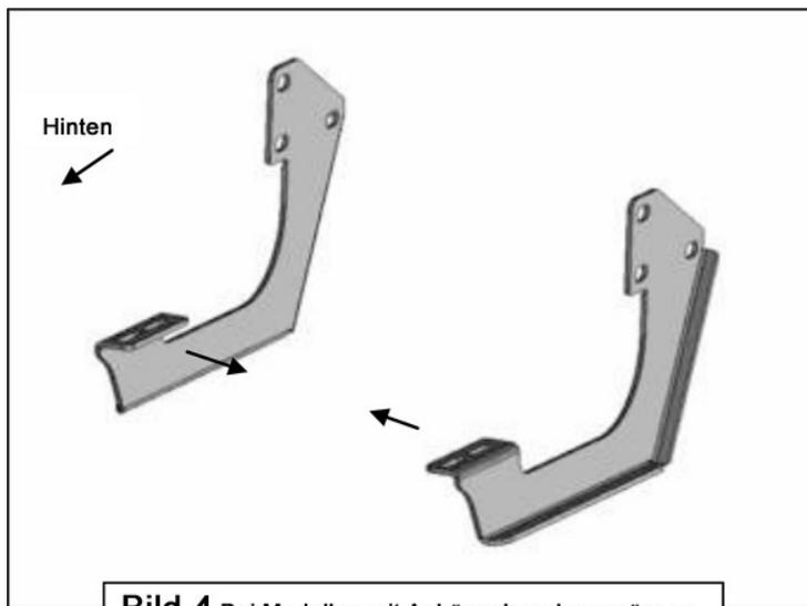
**Bild 4** Bei Modellen mit Anhängerkupplung müssen die Halterungen an der jeweils anderen Fahrzeugseite montiert werden. Die Montage erfolgt hierbei an der Außenseite des Rahmens.
