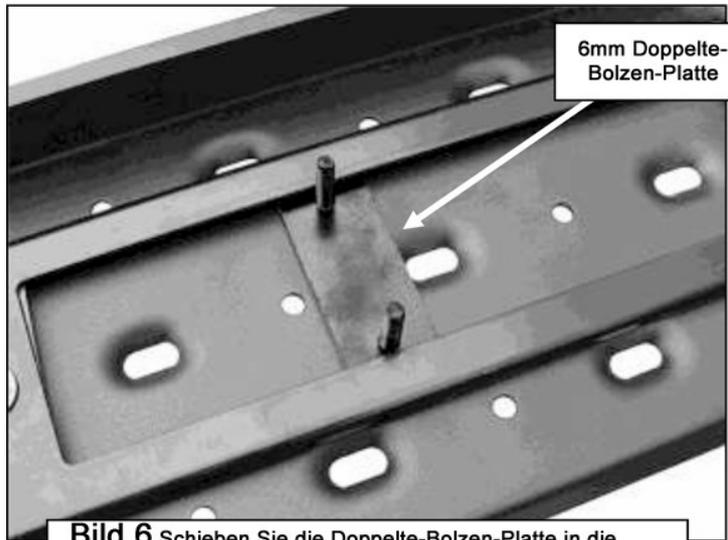
**Bild 6** Schieben Sie die Doppel-Bolzen-Platte in die Führungsschiene auf der Unterseite der Trittstufe.
