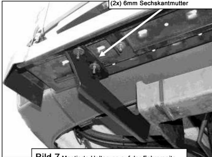
**Bild 7** Montierte Halterung auf der Fahrerseite mit vorhandener Anhängerkupplung.
