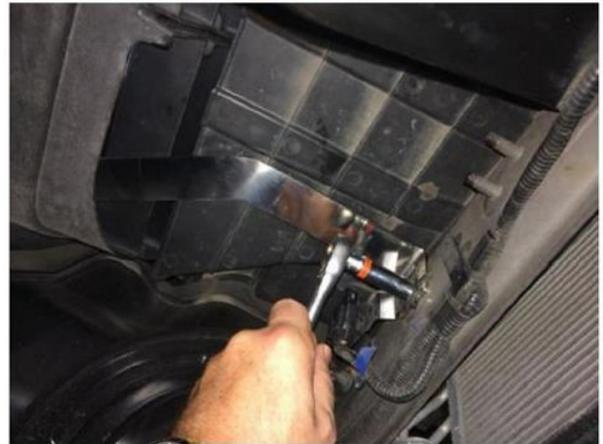
8) Befestigen Sie den Frontbügel an den bereits montierten Halterungen. Richten Sie den Frontbügel dabei korrekt am Fahrzeug aus.
