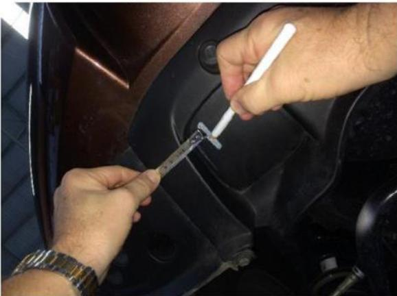
4) Führen Sie die U-Schraube (C) in die gezeigten Montagepunkte am Chassis ein.
