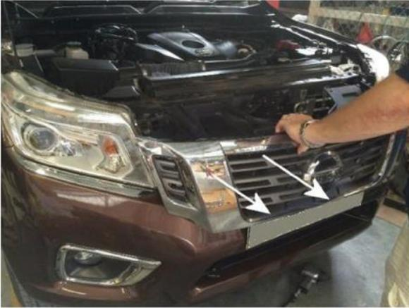
7) Montieren Sie die Halterungen B an der linken und rechten Fahrzeugseite. Ziehen Sie die Schrauben fest an.
