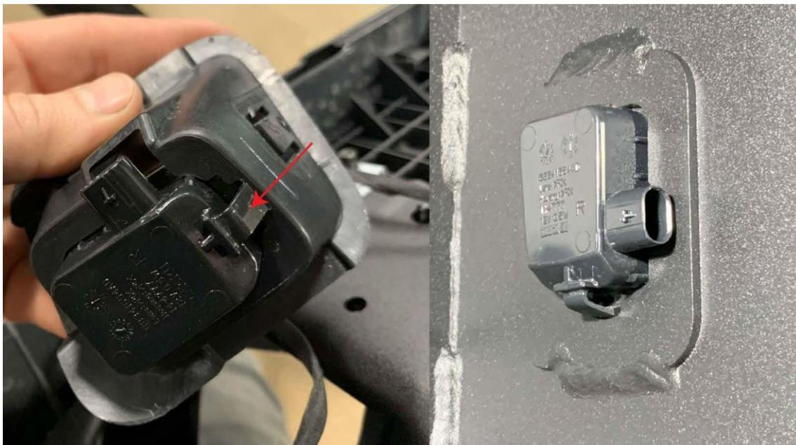
6. Optional: Sofern Rückfahrsensoren vorhanden sind, entfernen Sie diese von der originalen Stoßstange und anschließend die Gummidichtung vom Sensor. Schritt 7 und 8 zeigen Ihnen zwei verschiedene Möglichkeiten, wie Sie den Sensor an der neuen Stoßstange montieren können.
