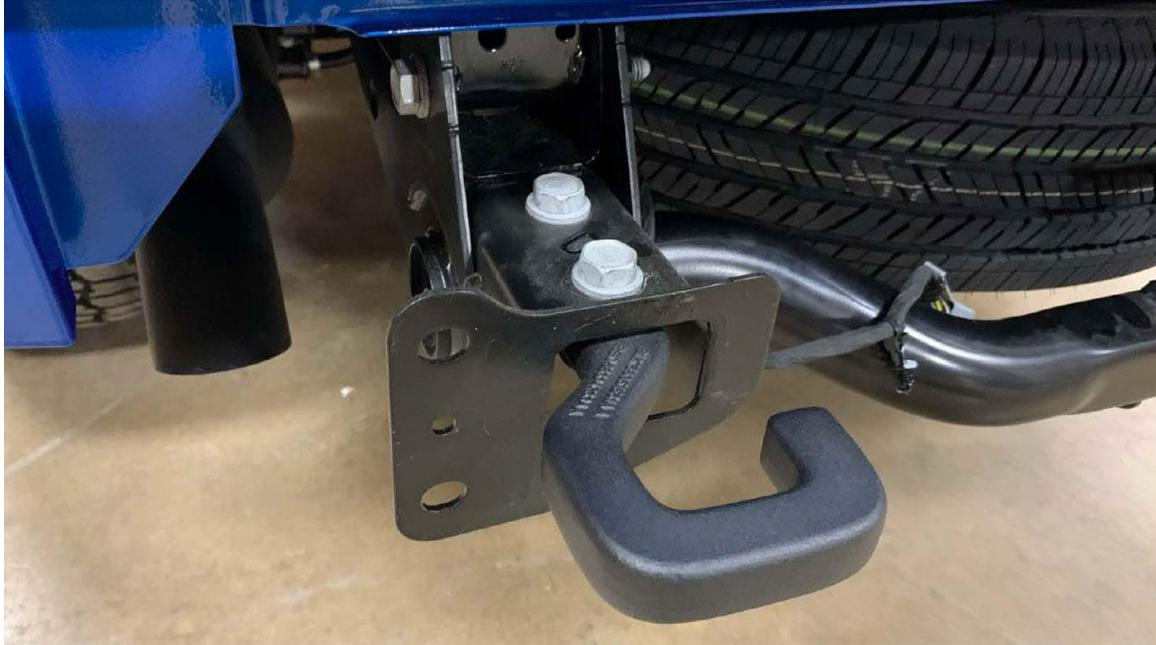
13. Montieren Sie die zusätzlichen Halterungen oben am Rahmenholm. Verwenden Sie hierfür (2x) M12 Sechskantschraube, (4x) M12 U-Scheibe, (2x) M12 Federring und (2x) Mutter je Halterung. Ziehen Sie die Schrauben nur handfest an.
