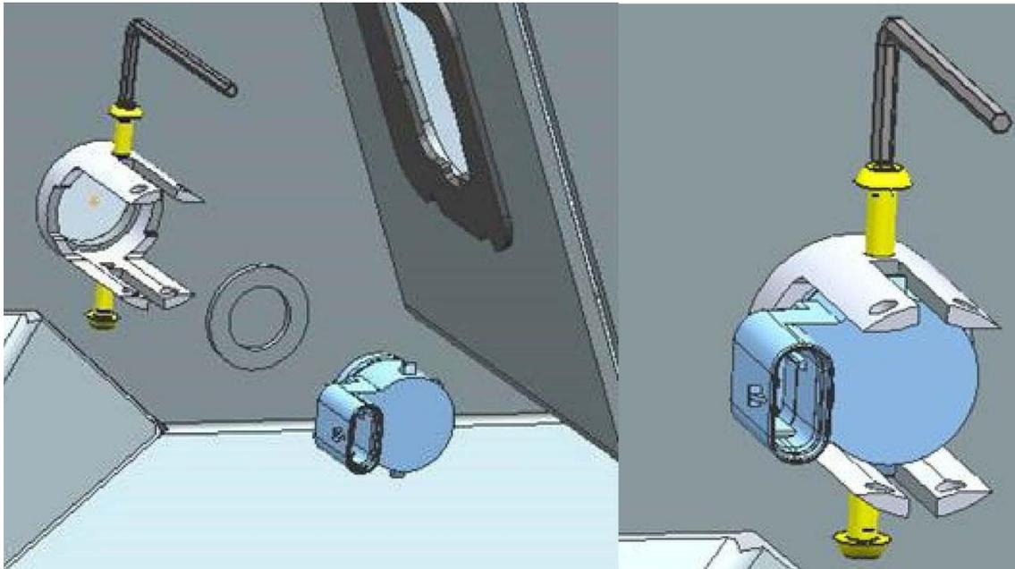
8. Sensor Montage 2: Befestigen Sie das runde Schaum Stück auf der Rückseite des Sensors. Drücken Sie anschließend den Sensor in die Stoßstange und clipsen Sie die Halteplatte auf die Stoßstange um den Sensor zu befestigen.
