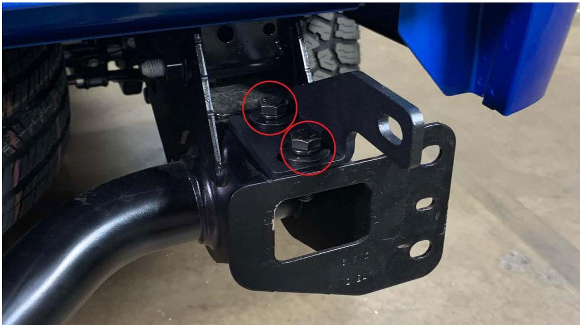
14. Befestigen Sie nun die Stoßstange am Fahrzeug. Befestigen Sie die Bolzen-Platte am Rahmen. Verwenden Sie hierfür (2x) M12 U-Scheibe, (2x) Federring und (2x) Mutter je Seite. Befestigen Sie die zusätzlichen Halterungen an der Stoßstange mit (1x) M12 Schraube, (2x) M12 U-Scheibe, (1x) M12 Federring und (1x) M12 Mutter-Platte. Ziehen Sie anschließend alle Schrauben fest an.
