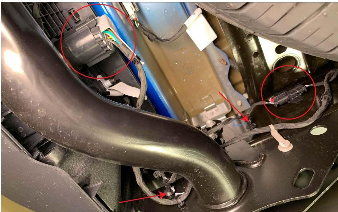
2. Verwenden Sie eine 16mm Nuss um die zwei Schrauben, die sich an beiden Seiten der Stoßstange befinden, zu entfernen
