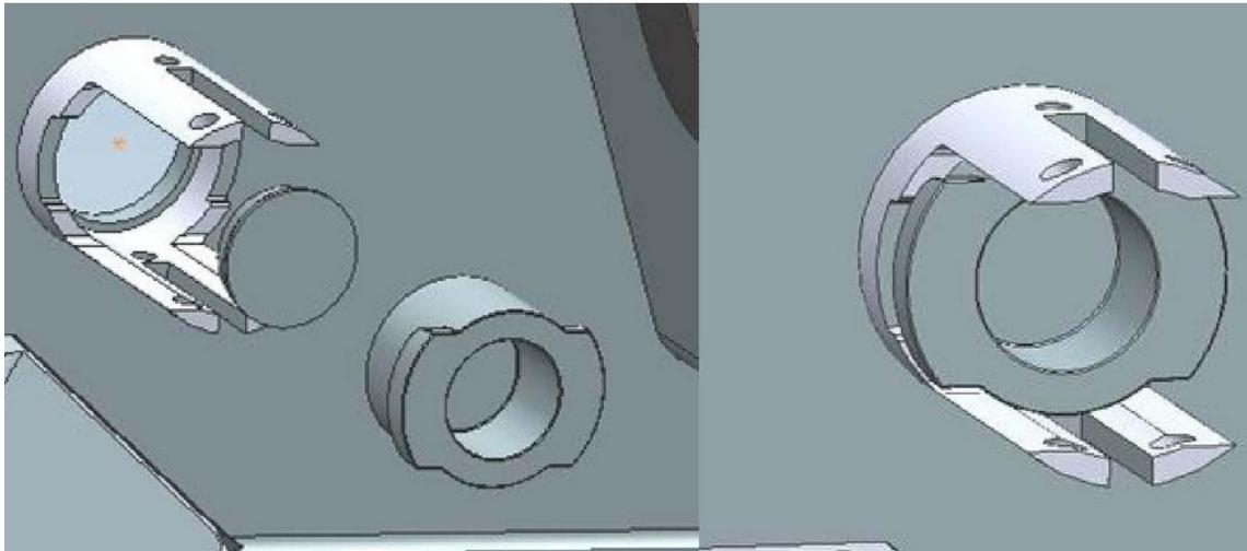
10. Führen Sie die Bolzen-Platte in die entsprechenden Öffnungen in der Stoßstange ein. Platzieren Sie dann die Kunststoffplatten auf den Bolzen. Diese halten die Platte, bei der Montage, in der richtigen Position.
