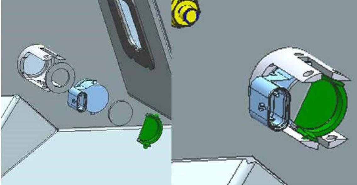
9. Kein Sensor vorhanden: Befestigen Sie den harten Gummistopfen an der Vorderseite des weichen Gummistopfens und drücken Sie beide Teile anschließend in die Stoßstange so dass der harte Gummistopfen mit der Außenseite der Stoßstange abschließt.
