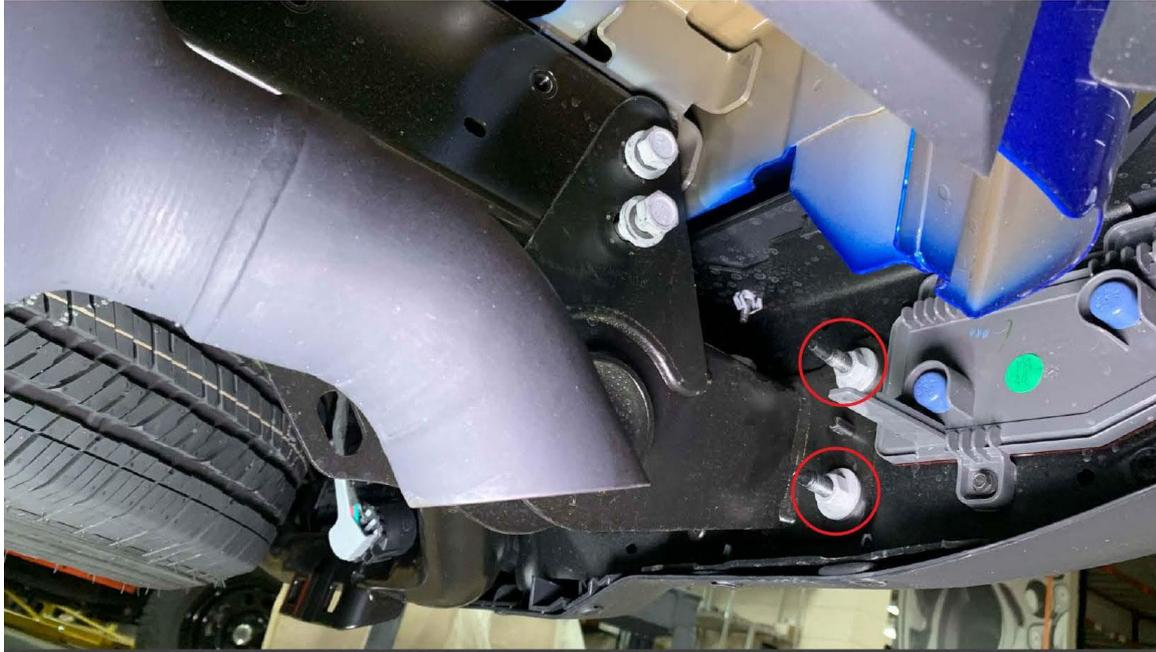
3. Entfernen Sie das Kennzeichen um die beiden letzten 16mm Schrauben zu entfernen, mit denen die Stoßstange am Fahrzeug befestigt ist. Nehmen Sie die Stoßstange vorsichtig ab und stellen Sie diese auf einen weichen Untergrund.
