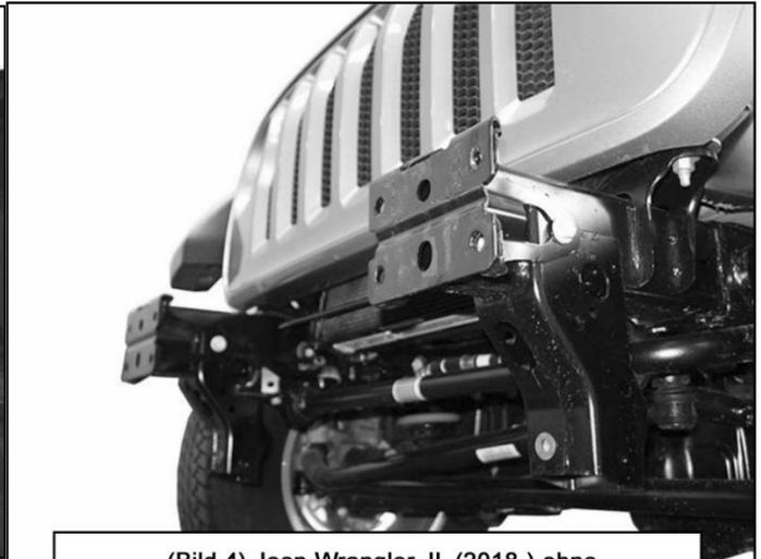
(Bild 4) Jeep Wrangler JL (2018-) ohne Frontstoßstange und Spritzschutz.
