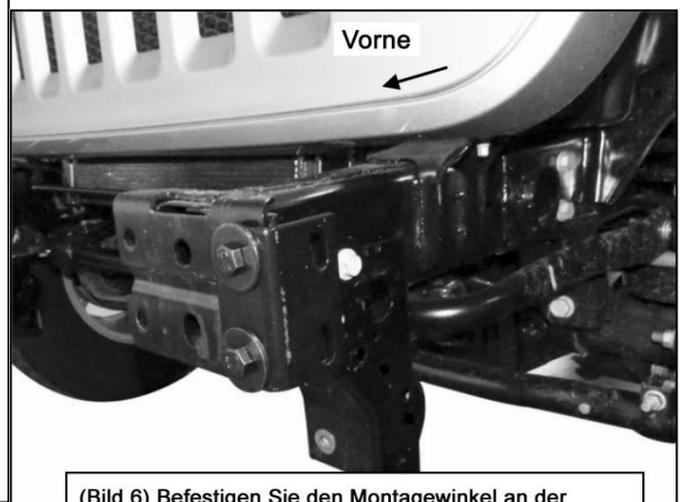
(Bild 6) Befestigen Sie den Montagewinkel an der Außenseite der Rahmenbefestigung auf der Fahrerseite.
