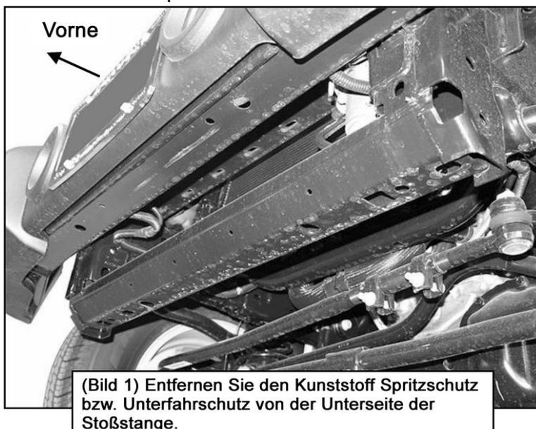
3. Lösen Sie bei Fahrzeugen mit Nebelscheinwerfern die Verkabelung, die zur Stoßstange führt, bevor Sie diese entfernen.
