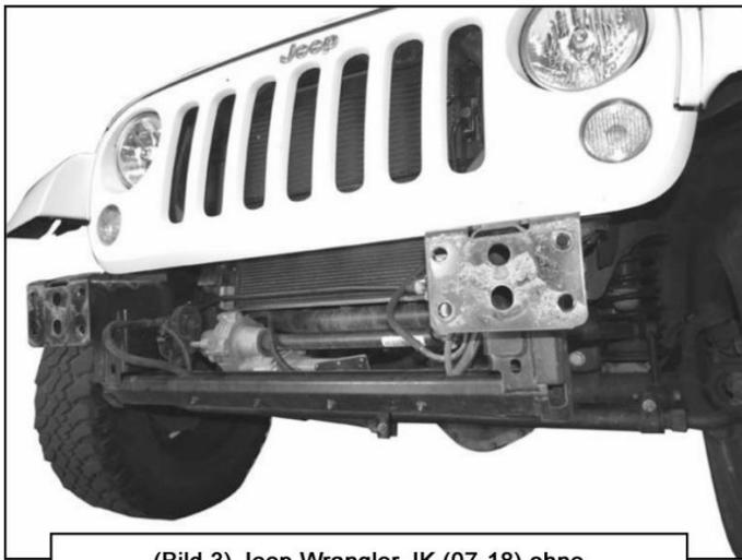
(Bild 3) Jeep Wrangler JK (07-18) ohne Frontstoßstange und Spritzschutz.
