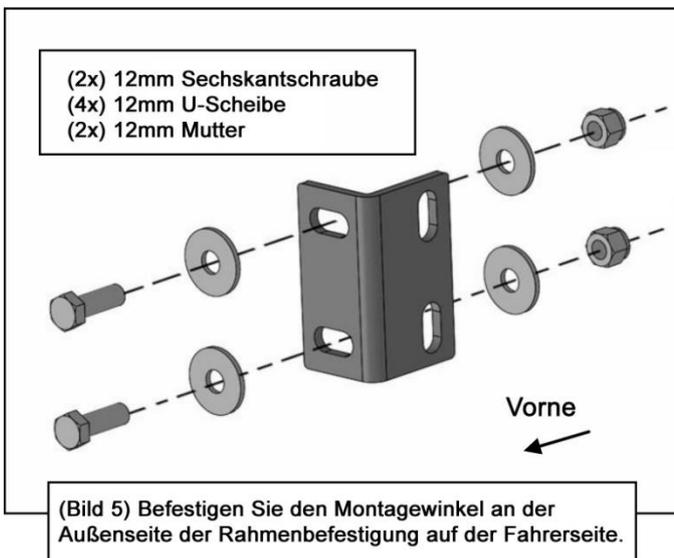
(Bild 5) Befestigen Sie den Montagewinkel an der Außenseite der Rahmenbefestigung auf der Fahrerseite.
