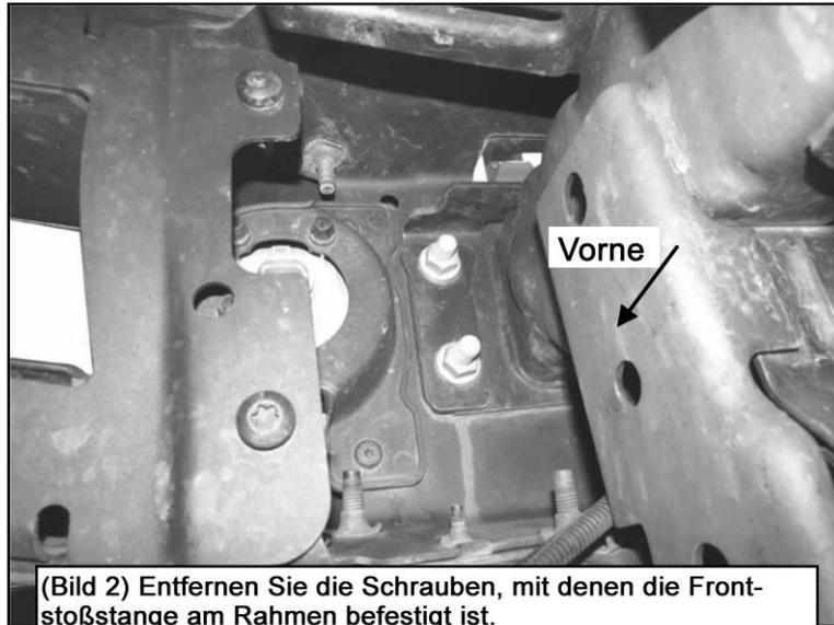
(Bild 2) Entfernen Sie die Schrauben, mit denen die Frontstoßstange am Rahmen befestigt ist. Abbildung zeigt die äußeren Bolzen der Fahrerseite des JK.
