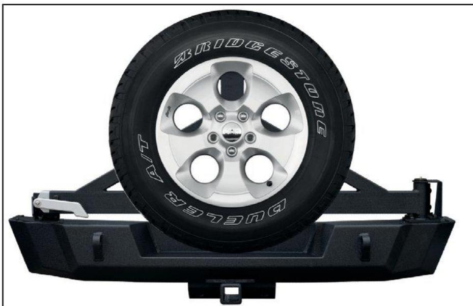
**25** Überprüfen Sie noch einmal alle Schraubverbindungen. Kontrollieren Sie, ob das Rad optimal am Halterahmen sitzt. Kontrollieren Sie auch, ob die Anschlagwinkel akkurat an den Türdämpfern anliegen. Über den Schmiernippel können Sie mittels einer einfachen Fettpresse das Gelenk mit zusätzlichem Fett versorgen, um auf Dauer eine einwandfreie Gangbarkeit des Gelenkes sicher zu stellen.
