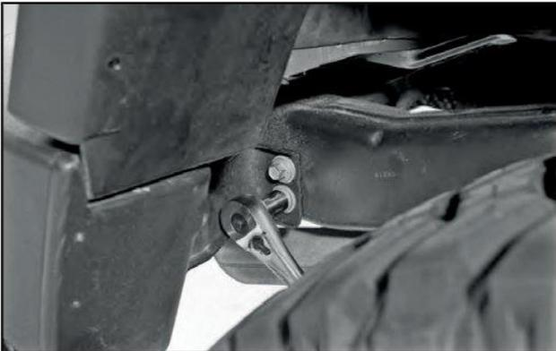
**3** Entfernen Sie die vier 15 mm Schrauben, die die Heckstoßstange halten. Falls an der Rahmenführung ein Abschlepphaken befestigt ist, demontieren Sie diesen. An Ihrer neuen Stoßstange befinden sich zwei stabile Ösen samt Schäkkel zum Abschleppen.
