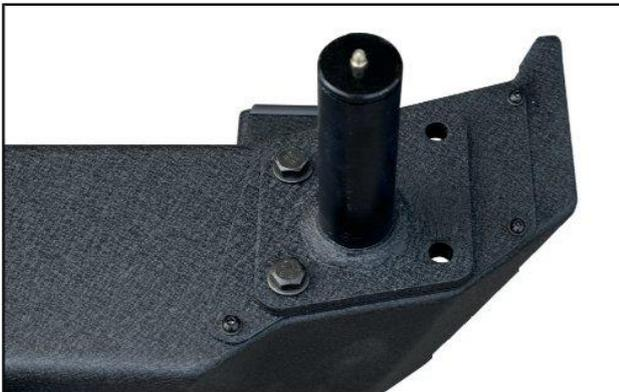
**10** Die Gelenkplatte wird zunächst links mit zwei Schrauben M12 x 45 befestigt. Achten Sie darauf, dass später die beiden anderen Schrauben in ihre Bohrungen passen. Oben auf der Gelenkachse ist bereits der kleine Schmiernippel verschraubt.
