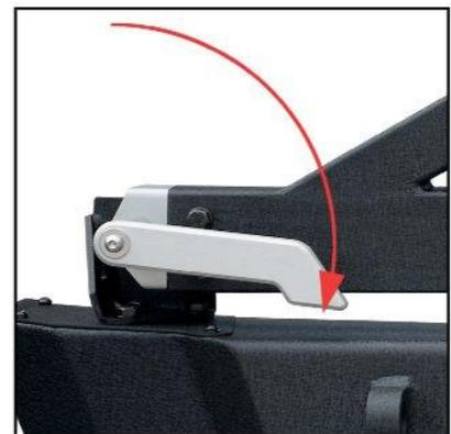
**23** Wenn die Einheit ausgeklappt ist, hängt der Verschlusshebel zwangsläufig nach unten. Zum Verriegeln halten Sie ihn bitte nach oben, rasten den Halterahmen in der Schlossplatte ein und drehen den Hebel im Uhrzeigersinn um 90°, bis der Rahmen fest verriegelt ist. Fertig!
