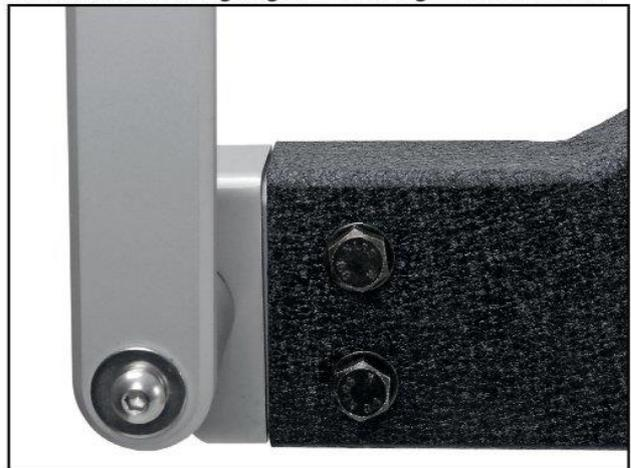
**22** Der Verschlusshebel (30) wird mit zwei M12 x 80 Schrauben gehalten.
