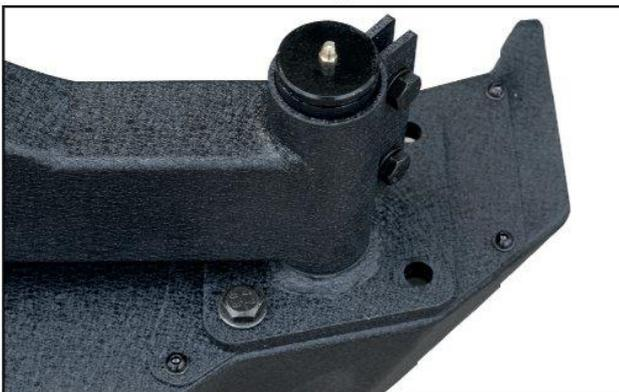
**12** Nun können Sie bereits den großen Trägerrahmen (21) auf die Gelenkachse stecken. Lassen Sie sich dabei helfen! Die beiden Sechskantschrauben M10 x 35 werden nun samt Scheiben und Muttern an den Scharnierlaschen angebracht.
