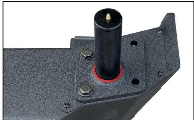
**11** Schieben Sie jetzt die erste Kunststoffbuchse (27, hier rot eingefärbt) auf die Gelenkachse.
