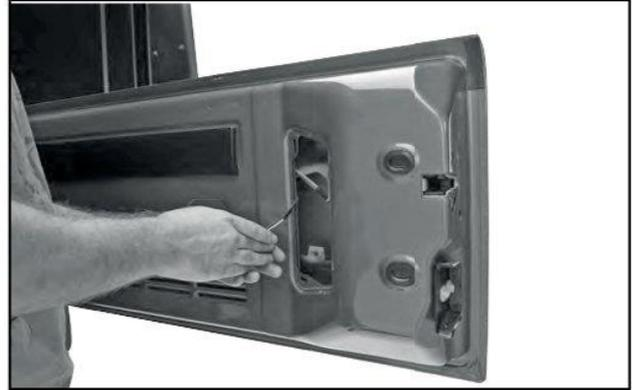
**2** Unterbrechen Sie die Verbindung des Kabelbaums zum dritten Bremslicht. Die Steckverbindung ist hinter der Abdeckung innen an der Hecktür zu finden.
