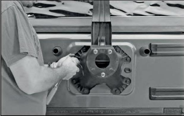
**1** Entfernen Sie das Reserverad und die acht 13mm - Bolzen, mit denen der originale Reserveradhalter an der Hecktür montiert ist.
