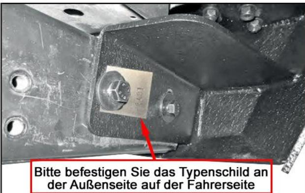
Bitte befestigen Sie das Typenschild an der Außenseite auf der Fahrerseite
