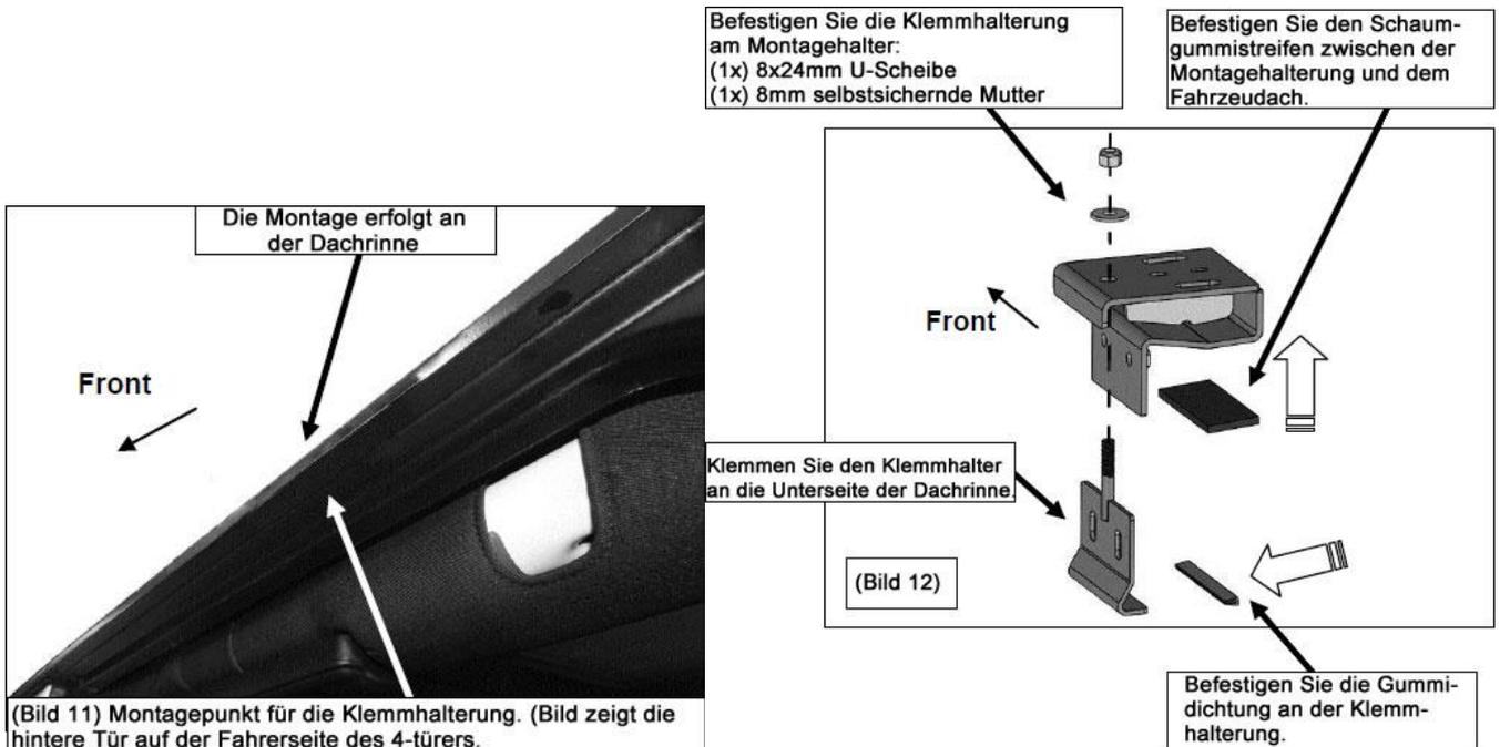
12. Befestigen Sie die Halterungen an der Dachrinne (**Bild 12 – 15**). Stellen Sie sicher, dass der Halter fest und sicher in der Dachrinne sitzt. **WICHTIG:** Bei 4-türigen Modellen platzieren Sie die Halterung ca. 32cm nach vorne ab dem Ende der Dachrinne. Bei 2-türigen Modellen sind es ca. 8cm. Verwenden Sie (2x) 8x25mm Halbrund—Kombischraube um die Klemmhalterung am Montagehalter zu befestigen, (**Bild 12 – 15**). Ziehen Sie die Schrauben nur handfest an.
