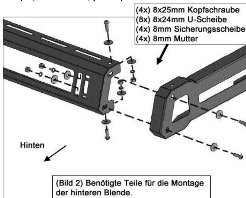
5. Nehmen Sie die Querträger und bestimmen Sie die 3 Montagepunkte auf beide Seiten der Seitenblenden. Befestigen Sie nun die Träger an den entsprechenden Punkten mit je (4x) 8x25mm Halbrundschaube, (4x) 8mm Sicherungsscheibe und (4x) 8mm U-Scheibe, **(Bild 3)**. Ziehen Sie die Schrauben nur handfest an.
