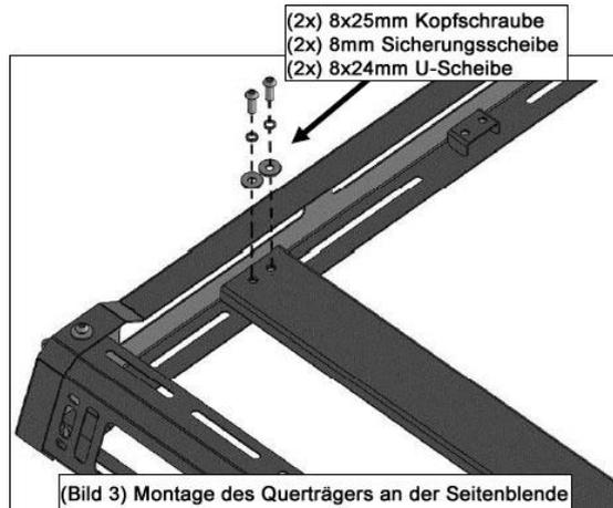
6. Richten Sie den Gepäckträger nach dem Zusammenbau korrekt aus und ziehen Sie die Schrauben/Muttern der Seitenblenden an den Front- und Rückblenden sowie die der Querträger fest an. Stellen Sie sicher, dass der Gepäckträger quadratisch ist, bevor Sie die Schrauben anziehen.
