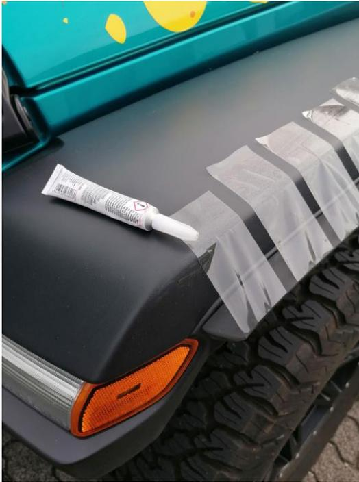
Wir empfehlen Ihnen die Enden der jeweiligen Verbreiterungen zusätzlich mit einem kleinen Tropfen des beiliegenden Spezialkleber zu befestigen und diese Enden ebenfalls zu fixieren.
