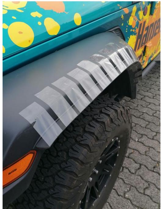
Nach dem Abziehen der Trägerfolie muss die Verbreiterung mindestens 3 Stunde mit hohem und gleichmäßigem Druck an die Fläche gedrückt werden. Hierfür können Sie z. B. ein breites Paket- oder Textilklebeband nehmen (siehe Abbildungen).
