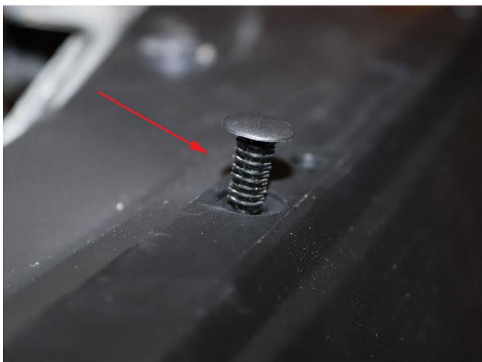
Die Kühlergrillblende sollte nun fest an Ihrem Fahrzeug montiert sein. Schließen Sie nun die Motorhaube wieder und überprüfen Sie in regelmäßigen Abständen den festen Sitz der Schrauben bzw. Nieten der Blende.
