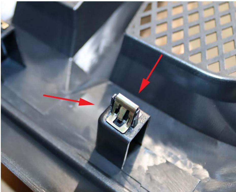
Nun versuchen Sie bitte mit etwas Druck die Klammern in die unteren Aufnahmepunkte am Fahrzeug zu schieben. Diese sollten dann dort einrasten. Im oberen Bereich wird die Kühlergrillblende mit den 8 Karosseriestiften an den bereits montierten Halterungen befestigt. Dazu drücken Sie bitte die Blende fest an das Fahrzeug / den Halter und stecken die Stifte in die vorhandenen Löcher zur Befestigung.
