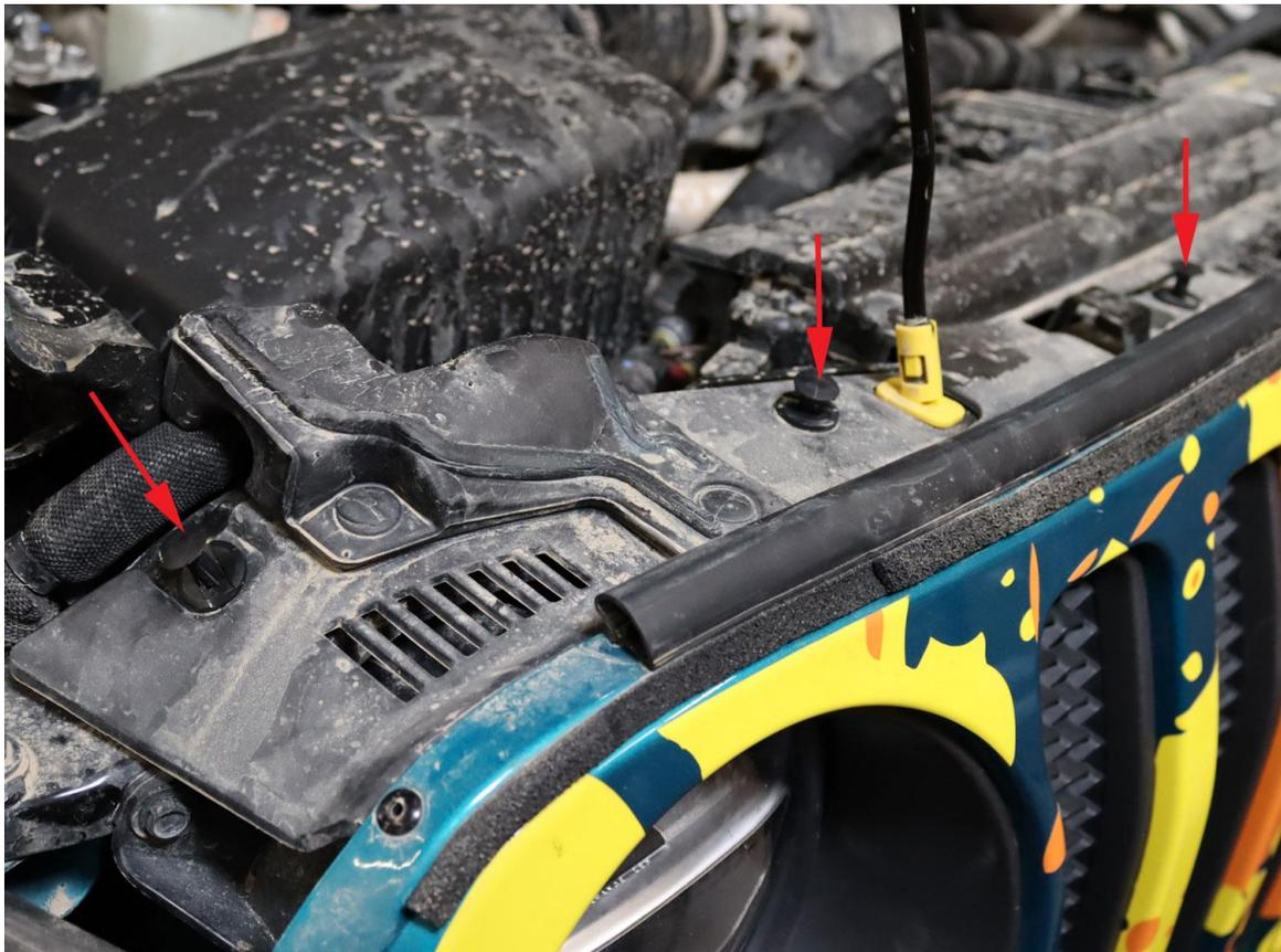
Damit ist der obere Bereich der Kühlergrillblende gelöst. Im unteren Bereich ist die Blende nur geklemmt. Hierzu nehmen Sie bitte beide Hände an eine Seite der Blende und versuchen diese durch gleichmäßiges ziehen und wackeln zu lösen. Das gleiche machen Sie bitte auf der anderen Seite. Dann ist die Blende gelöst und kann entnommen werden.
