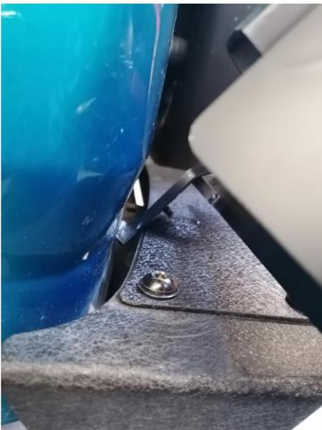
Schritt 1 = Führen Sie die angeschweißte Befestigung des Kennzeichenhalters in den Spalt zwischen der Karosserie und der Heckstoßstange. Bei einigen Stoßstangen kann es sein, dass dieser Spalt nicht groß genug ist. Dann lösen Sie bitte die Heckstoßstange ein wenig, so dass sich der Spalt vergrößert und die Befestigung eingeschoben werden kann. Die Stoßstange muss nicht komplett abgenommen werden.
