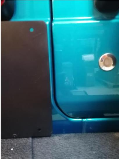
Schritt 3 = Bitte prüfen Sie den Abstand zwischen dem Kennzeichenhalter und der Hecktür. Dieser Abstand muss so gewählt werden, dass sich die Tür noch ohne Probleme öffnen und schließen lässt.
