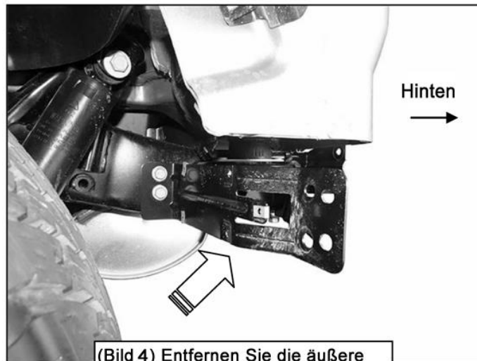
(Bild 4) Entfernen Sie die äußere Stoßstangenhalterung vom Rahmen
