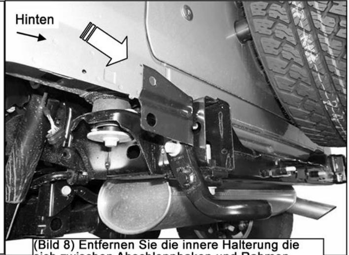
(Bild 8) Entfernen Sie die innere Halterung die sich zwischen Abschlepphaken und Rahmen befindet.
