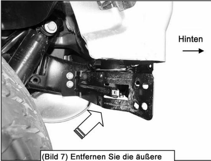
(Bild 7) Entfernen Sie die äußere Stoßstangenhalterung vom Rahmen
