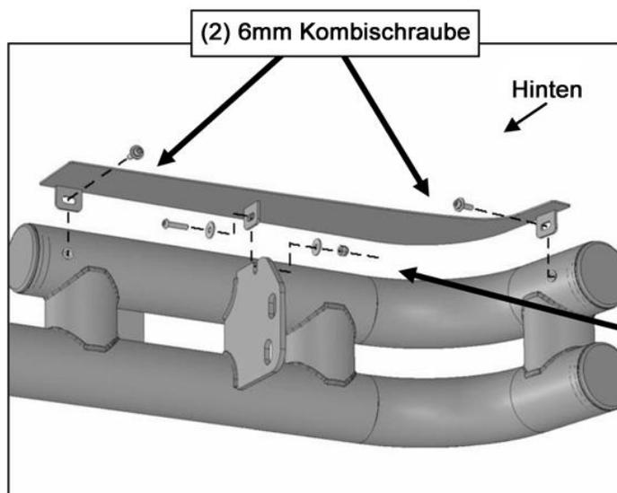
(Bild 1) Befestigen Sie die Abdeckung für die Fahrerseite an der Rückseite der Stoßstange
