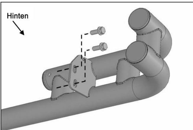
(Bild 9) Verwenden Sie die originalen Sechskantschrauben um die Stoßstange am Rahmen und an der Außenseite des Abschlepphakens zu befestigen.
