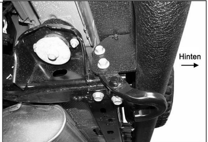
(Bild 10) Befestigen Sie die Stoßstange am Rahmen und an der Außenseite des Abschlepphakens.
