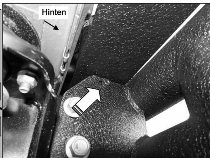
(Bild 3) Befestigen Sie die mittlere Lasche an der Oberseite der Stoßstange.
