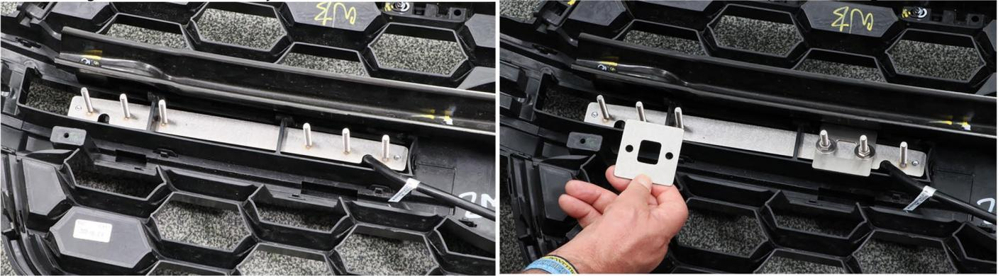
Setzen Sie auf das Gewinde jeweils eine Unterlegescheibe und dann die Muttern und ziehen diese mit einem Schraubenschlüssel fest. Achten Sie darauf das die Halterung nicht verrutscht.
