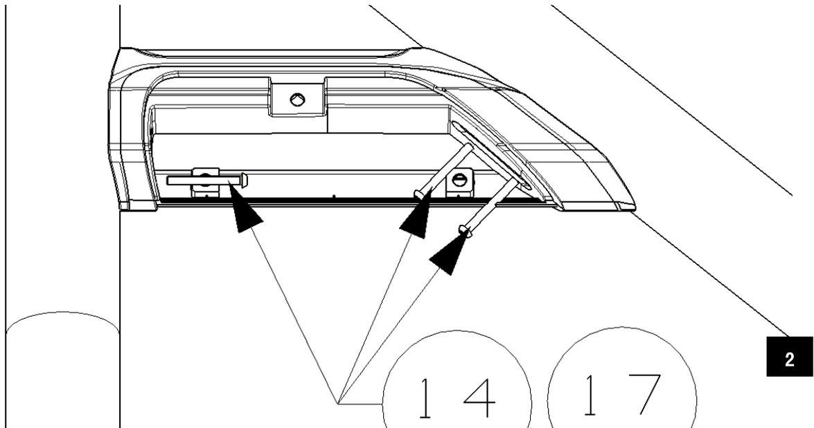
Schritt 2: Befestigen Sie die linken und rechten Seitenteile mit den entsprechenden Schrauben am vorderen und hinteren Bügel (Bild 2).
