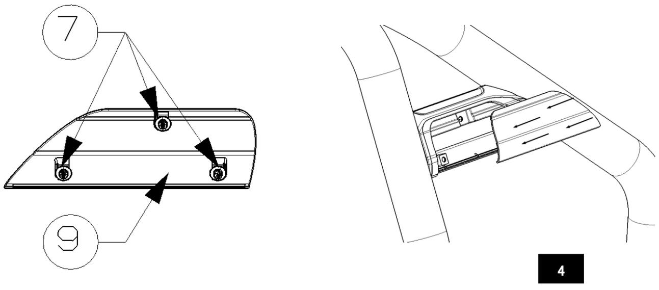
Schritt 3: Montieren Sie zuerst die Kunststoff Verschlüsse an den Seitenschalen (Bild 3) und drücken Sie dann die Cover auf die Seitenschalen (Bild 4).
