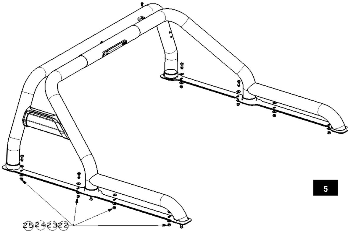
Schritt 4: Befestigen Sie die Montagehalterungen mit den entsprechenden Schrauben auf der Laderaumkante (Bild 5)
