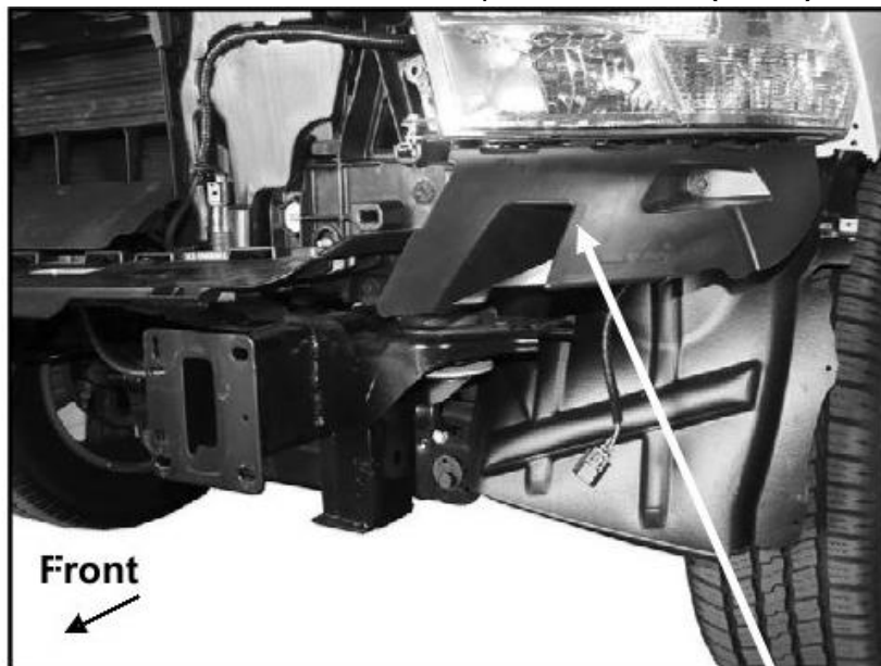
(Bild 7) Entfernen Sie den Kunststoffblock unter dem Hauptscheinwerfer.
