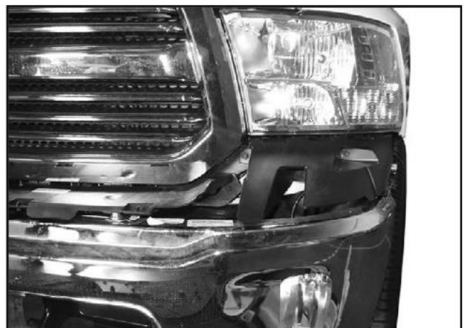
(Bild 4) Entfernen Sie die Frontblende von der Oberseite der Frontstoßstange.
