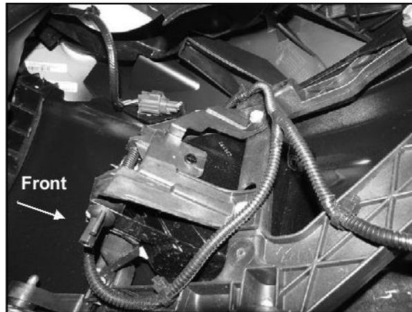
(Bild 2) Ziehen Sie die Steckverbindungen der Leuchten sowie Sensoren, sofern vorhanden. Ziehen Sie den Kabelstrang ab und bewegen Sie diesen zur Seite.
