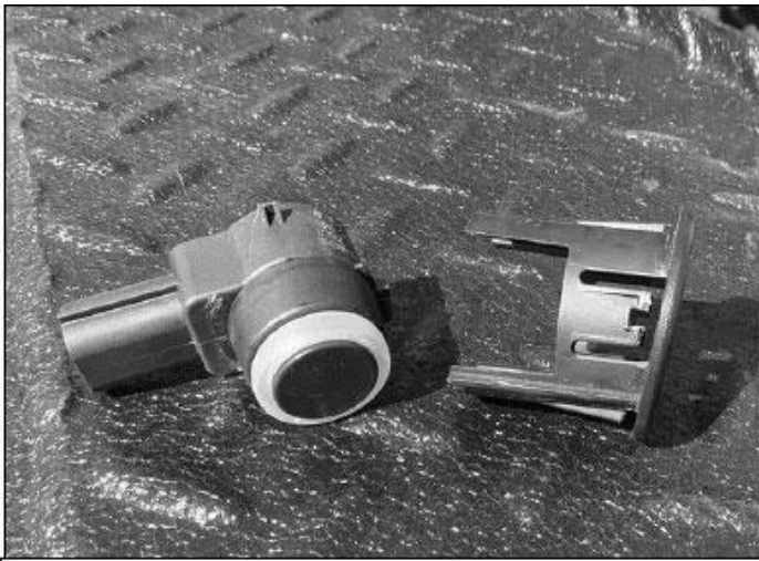
(Bild 11) Entfernen Sie die Führungsschiene von jedem Sensor.
