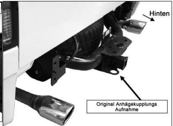
(Bild 5) Heckstoßstange vollständig entfernt
