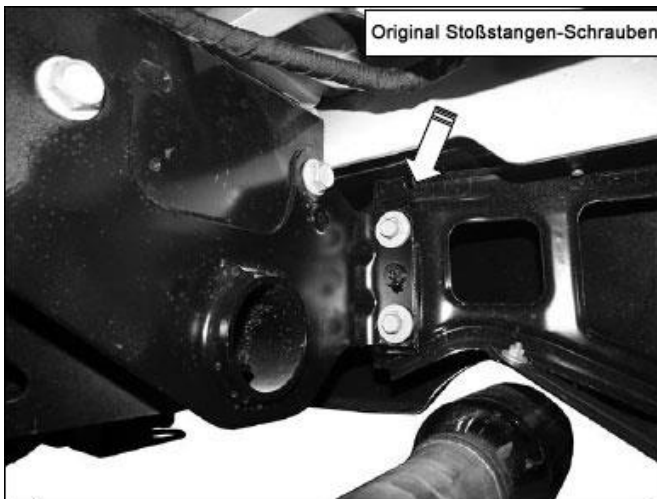
(Bild 4) Beispiel der originalen Stoßstangen Halterung mit zwei Sechskantschrauben. Ansicht von hinten.
