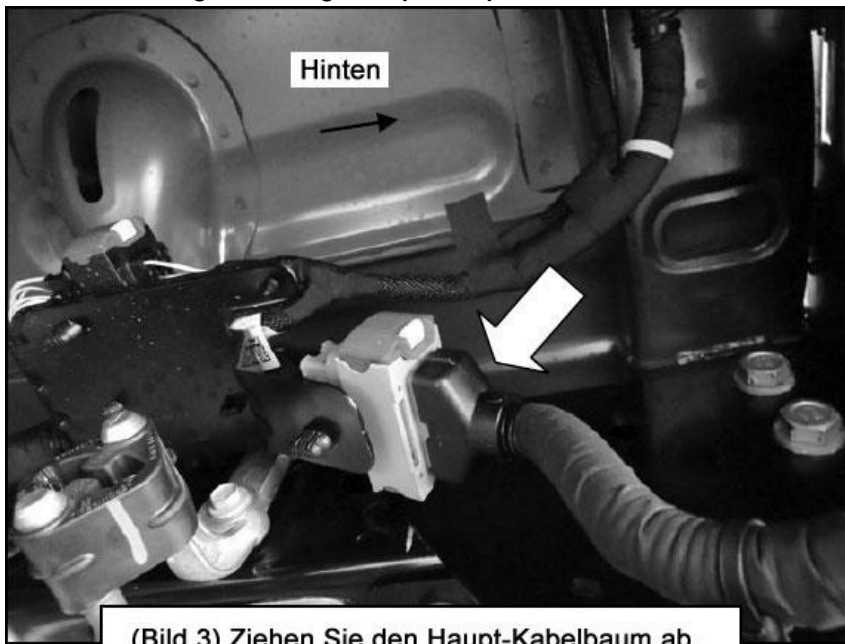
(Bild 3) Ziehen Sie den Haupt-Kabelbaum ab.
