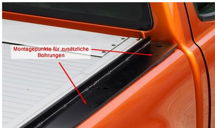
Demontieren Sie die Leisten wieder. Bohren Sie nun, mit einem 8mm Bohrer, je zwei Löcher senkrecht durch die Ladebordwand, sowie durch das Versteifungsblech. Entgraten Sie die Bohrlöcher und streichen etwas Rostschutz auf die Bohrlöcher auf.
