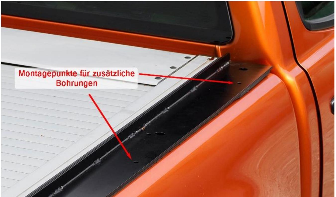
Demontieren Sie die Leisten wieder. Bohren Sie nun, mit einem 8mm Bohrer, je zwei Löcher senkrecht durch die Ladebordwand, sowie durch das Versteifungsblech. Entgraten Sie die Bohrlöcher und streichen etwas Rostschutz auf die Bohrlöcher auf.
