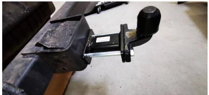
Schieben Sie nun die neue Stoßstange auf die Halterungen und befestigen sie diese mit dem Befestigungsmaterial (Nr.5&6). Ziehen Sie die Schrauben nur handfest an. Richten Sie die Stoßstange aus, über die Langlöcher der Befestigungshalter kann die Position verändert werden. Ziehen Sie im Anschluss alle Schrauben fest an.
