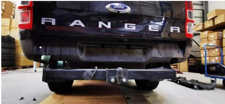
Lösen Sie nun die 3 Schrauben der Halterung der AHK am Rahmen. Bitte beachten Sie, die Schrauben 1 und 3 werden durch eine angeschweißte Mutter im Rahmenstempel gekontert. Die Schraube 2 wird durch eine lose Mutter gekontert.
