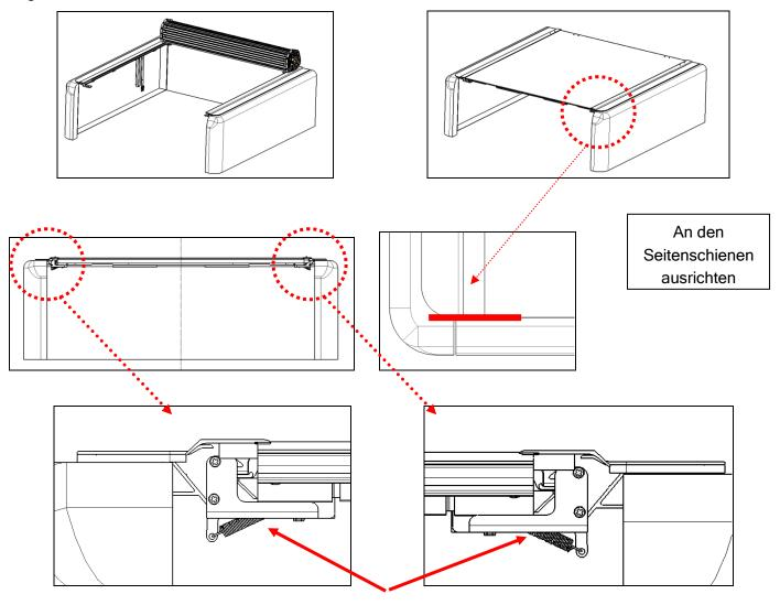
Vergewissern Sie sich, dass sich die obere Abdeckung in der mittleren Position befindet, der Abstand zwischen der Endkappe und den beiden Seitenschienen sollte gleich sein.
