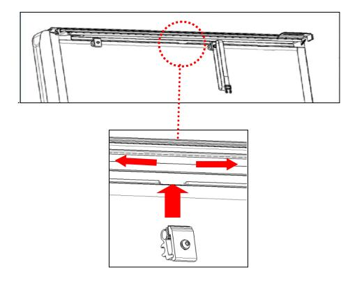
Üben Sie Druck auf die Befestigungsschiene aus und ziehen die Klammern fest an.
