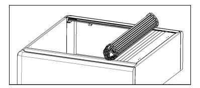
Rollen Sie die Abdeckung nach vorne, schieben Sie die Schraube (7) an der Unterseite in die vordere Lamelle. Ziehen Sie dann die Muttern an.
