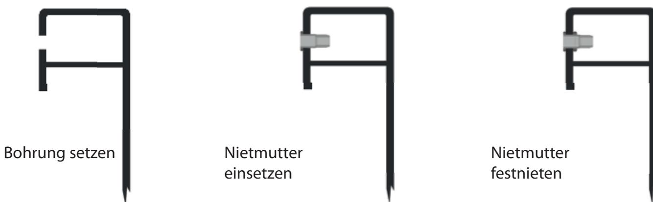
Unten: Das Halteblech des Bügels kann einfach über den Flachkopf der Blindnietmutter geschoben werden, der Flachkopf ist maximal 2 mm hoch (links). Eine M12 Schraube samt Federscheibe genügt nun zur Befestigung (rechtes Bild).
