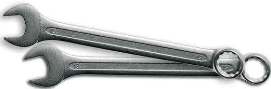
Links: Die 12 mm Schrauben und Muttern werden mit 19 mm Schlüsseln angezogen, M10 Schrauben und Muttern mit 17 mm Schlüsseln.
