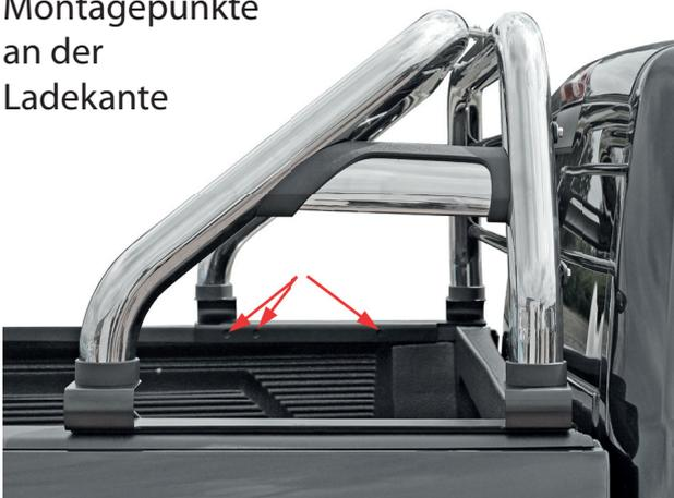
*Bedenken Sie schon jetzt, dass Sie links knapp hinter oder unter dem Halteblech eine Bohrung IN DIE BORDWAND machen müssen, in die das Kabel für das zusätzliche Bremslicht geschoben wird! Dieses Kabel wird dann nach hinten geführt und muss durch eine weitere Bohrung zur Heckleuchte gelangen, wo die Bremsleuchte parallel zum Heckleuchtenbremslicht angeschlossen wird. Details dazu finden Sie am Ende dieser Anleitung.*
