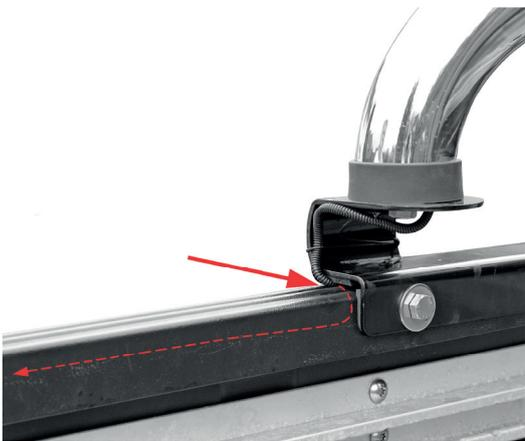
Oben: Das Kabel läuft aus dem Bügel über das Halteblech IN das Bordwandinnere.
