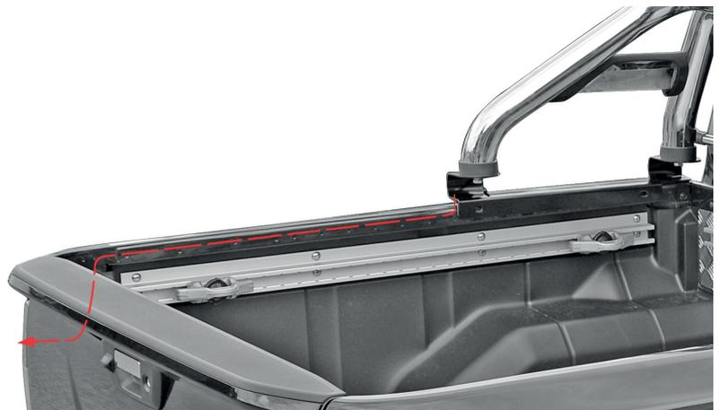
Oben: Hier verläuft das Kabel in der Falz der Bordwand nach hinten zur Heckleuchte.
