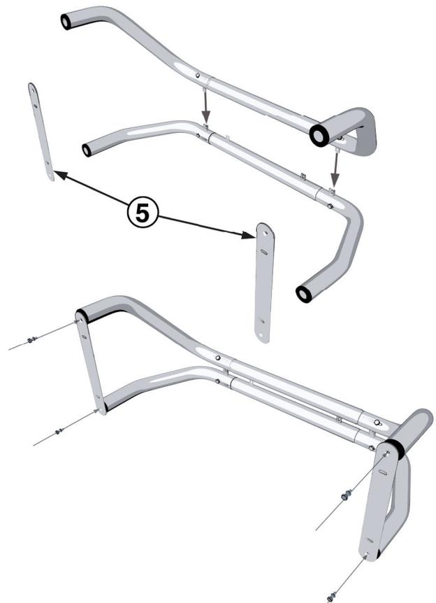
Rechts: Befestigen Sie nun die Haltestrebe mit zwei Innensechskantschrauben M8 x 40 an den äußeren Laschen der Mittelrohre. Die Laschen sollten übereinander liegen, wenn die Bügel optimal ausgerichtet sind. Die Schrauben werden durch das 10 cm lange Langloch der Halteleiste geführt. Benutzen Sie auch hier die beigelegten Unterlegscheiben und Federringe! Nun können Sie die 4 Schrauben unter den Grundplatten endgültig festziehen.
