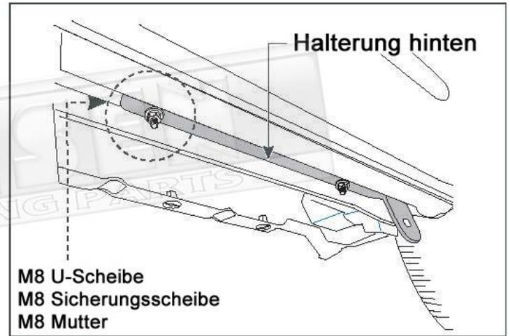
6. Befestigen Sie nun die vorderen und hinteren Halterungen. Verwenden Sie hierzu die M8 Muttern, U-Scheiben und Sicherungsscheiben.
