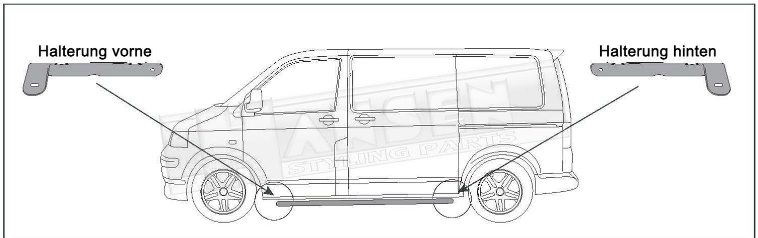
2. Legen Sie die Halterungen für die linke und rechte Seite zur Seite. Reinigen Sie die Flächen, an denen die Halter montiert werden, gründlich
