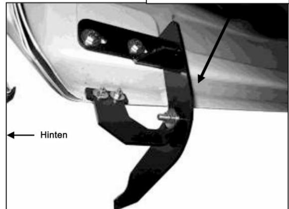
Bild 18 Montage der Halterung auf Fahrerseite hinten
