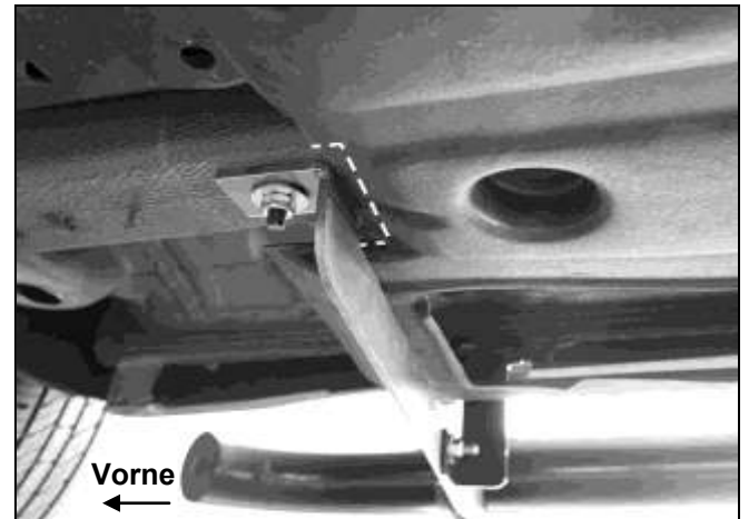
(Bild 16) Abdeckung einschneiden um Platz für den Halter zu schaffen (Beifahrerseite Halterung vorne)
