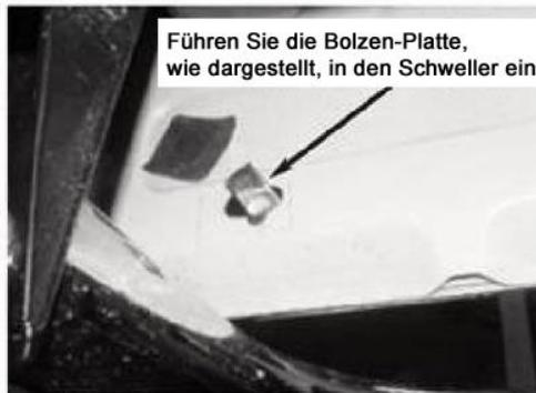
Bild 3 - Hintere Bolzen-Platte
