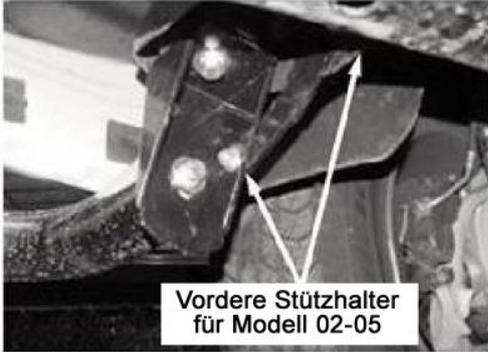
Bild 1 - Halterung vorne (Fahrerseite)
