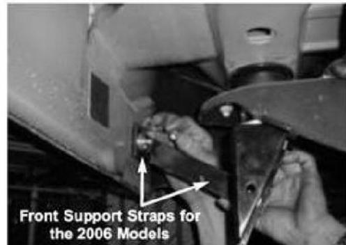
Bild 5 - Vordere Halterung (Fahrerseite)
