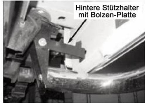
Bild 2 - Halterung hinten (Fahrerseite)
