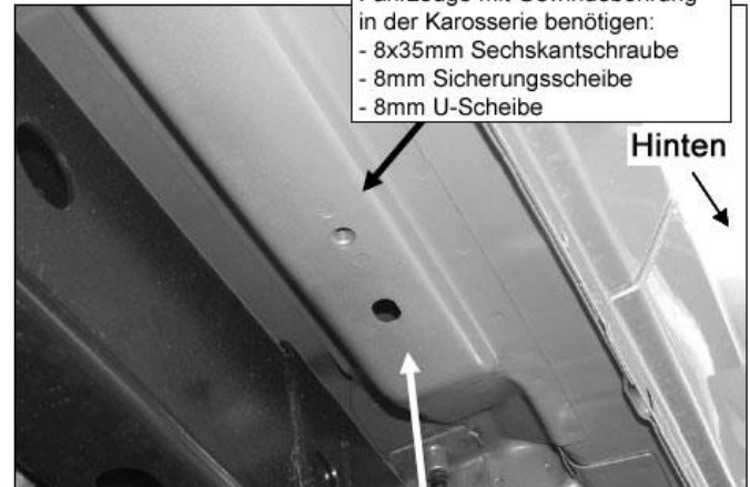
(Bild 2) Beispiel der Baujahre von 2010-2015 mit geschlossenem Unterboden und 8mm Gewindebohrungen. Hier wird die 10mm Mutter Platte nicht benötigt.
