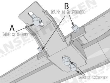
Die einzelnen Befestigungswinkel werden mit je einer M8 x 30mm (A) und zwei M8 x 20mm Schrauben (B) am Bodenblech des Fahrzeugs
