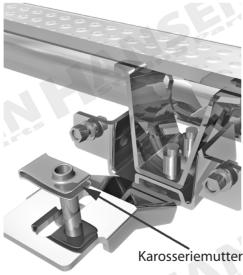
Das Bodenblech des Jeeps weist links und rechts zwei Metallstreifen auf, die in regelmäßigen Abständen mit Bohrungen versehen sind. Hier werden die Befestigungswinkel mittels M8 x 20mm-Schrauben gehalten. Der Schraubenkopf sollte zur Fahrzeugaußenseite zeigen.
